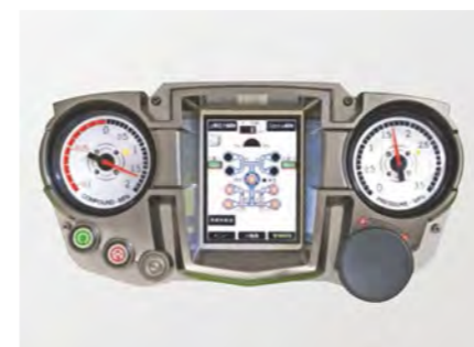
پنل نمایشگر لمسی آسان برای عملیات پمپ
