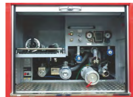
پمپ آب PTO با جریان ۳۰۰۰ لیتر در دقیقه
